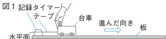
この結果得られたテープの打点の間隔が等しくなったのは最初の打点を基準点とし、基準点から6打点ごとに切り取った。図2は、この切り取ったテープを時間経過順にテープ①～⑤とし、貼り付けたものである。
