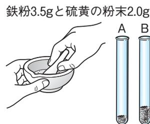
② 2本の試験管 A、B に磁石を近づけ、つき方を比べる。また、試験管 A、B の中身を少量取り出し、それぞれに薄い塩酸を 2、3 滴加え、発生する気体を [ 手であおいでにおいを調べる ]。調べたら、[ 水 ] を加えて [ 気体の発生を止める ]。
